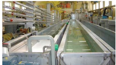
Abbildung 14: Automatische Fertigungsstraße zur Oberflächenbehandlung – Quelle: Web
