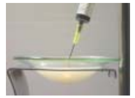
Dispositions expérimentales pour la détection du transfert de chaleur dans la couche de gel. Au début du chauffage, nous avons injecté une goutte d'encre au milieu du gel. Le transfert de chaleur par convection entraîne le déplacement des molécules d'encre dans le flux calorifique.
